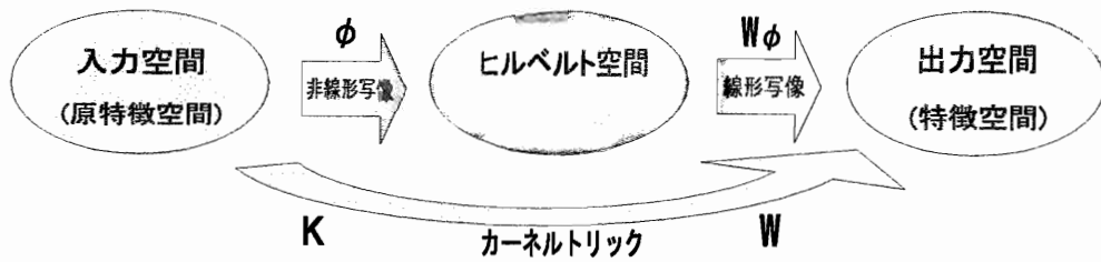
図 3.2: KL 法の構成. KL 法はヒルベルト空間における像の分布が Lotlikar の仮定を満たすとし, LL 法を用いて出力空間への線形写像を求めることにより, 非線形な次元圧縮を実現する. 本論文ではカーネルトリックにより非線形写像 \phi を計算することなく出力空間への写像を求める.
