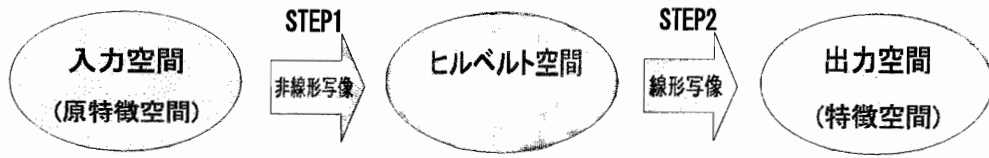
図 3.1: 非線形適応的次元圧縮法の基本構成. 入力パターンをはるかに高次元なヒルベルト空間へ写像し, ヒルベルト空間における像に LL 法を適用することで識別に最適な出力空間への写像を求める.
