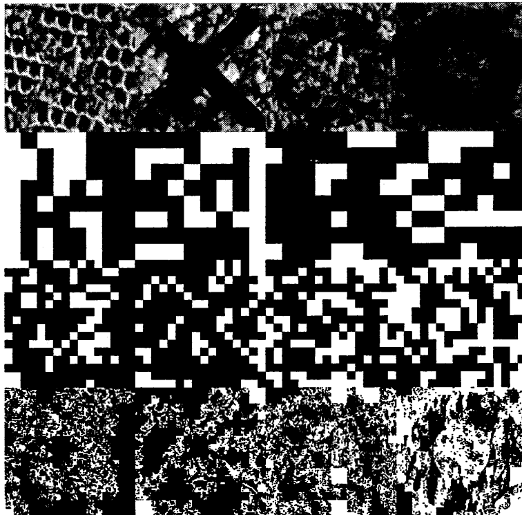
図 4.11: 領域分割の初期段階でテクスチャ境界と関係のない領域分割したときの例 (上から順に入力画像, 実験1の r の特徴量に重みをつけ \theta は 45^\circ おきの結果, 実験2の 8 \times 8 の結果, 実験3の結果)
