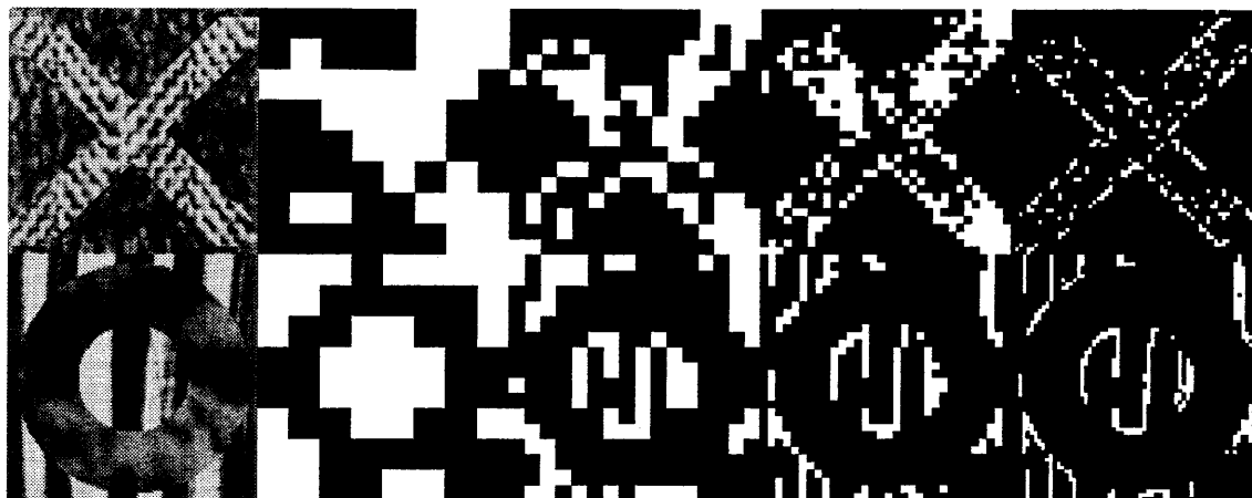
図 4.7: 終了条件である小領域の大きさが小さくなるほど認識率が下がる結果 (左: 入力画像, 左 2 番目から順に終了条件の小領域の大きさが 16 \times 16 , 8 \times 8 , 4 \times 4 , 2 \times 2 の結果)
