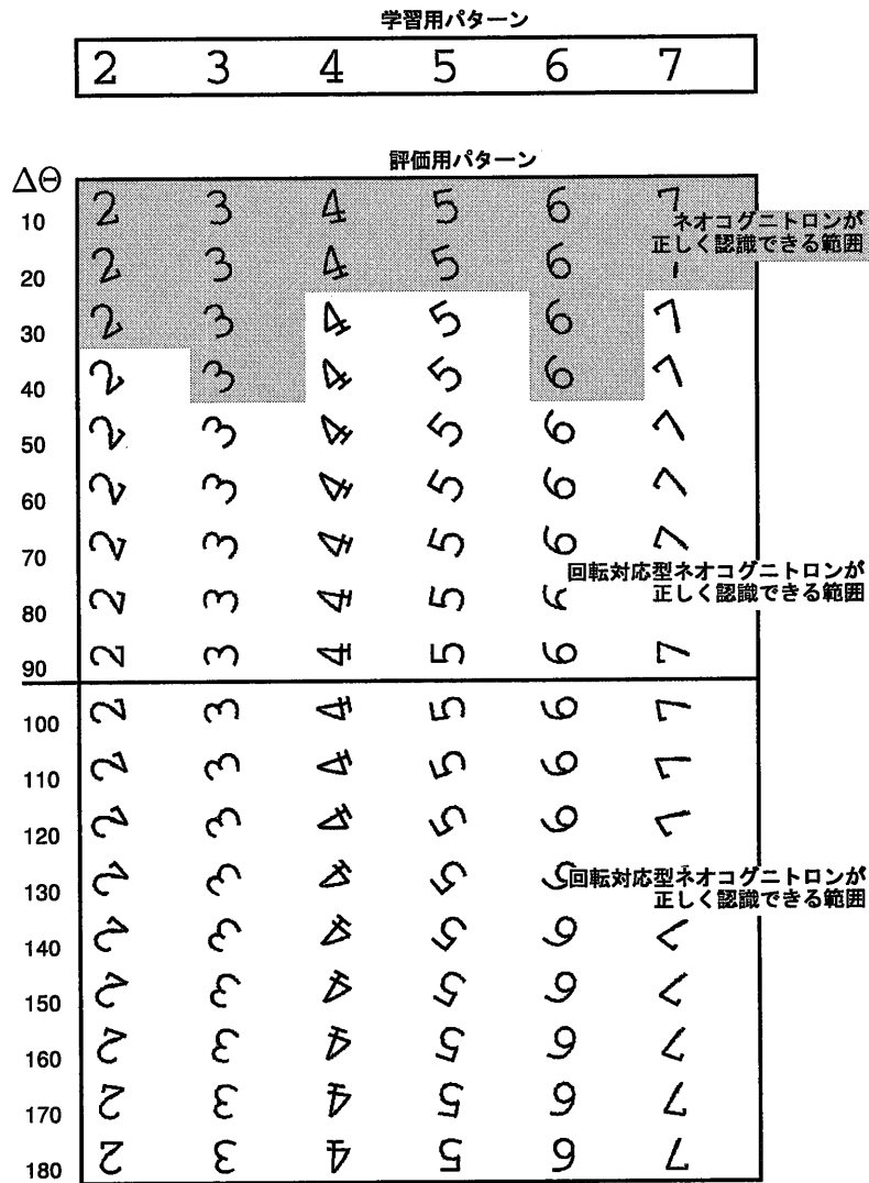
図 3.9: 回転対応型ネオコグニトロンの回転したパターンに対する認識結果。灰色の部分は従来型ネオコグニトロンが認識できる範囲を示す。回転対応型ネオコグニトロンはパターンの回転に対して完全に頑健であることがわかる。
